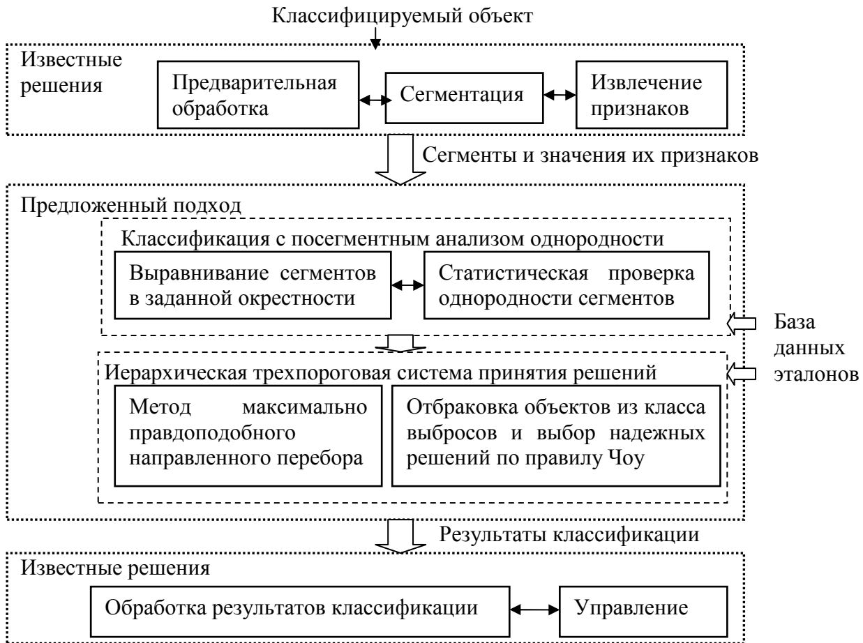
Рис. 1 Методология посегментного анализа однородности для систем классификации
