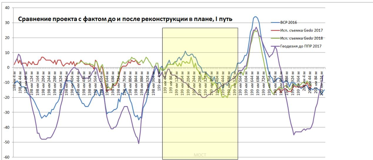
**Рис. 4** Сравнение проекта модернизации со съемками до реализации проекта и после, в плане
