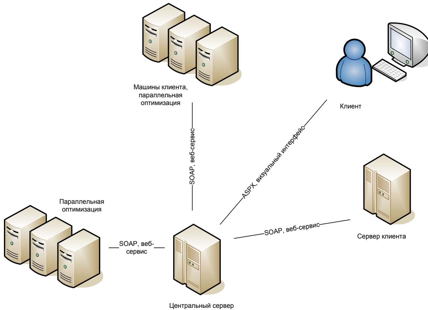
Функциональная схема предоставления вычислительных алгоритмов распознавания образов удаленным клиентам
