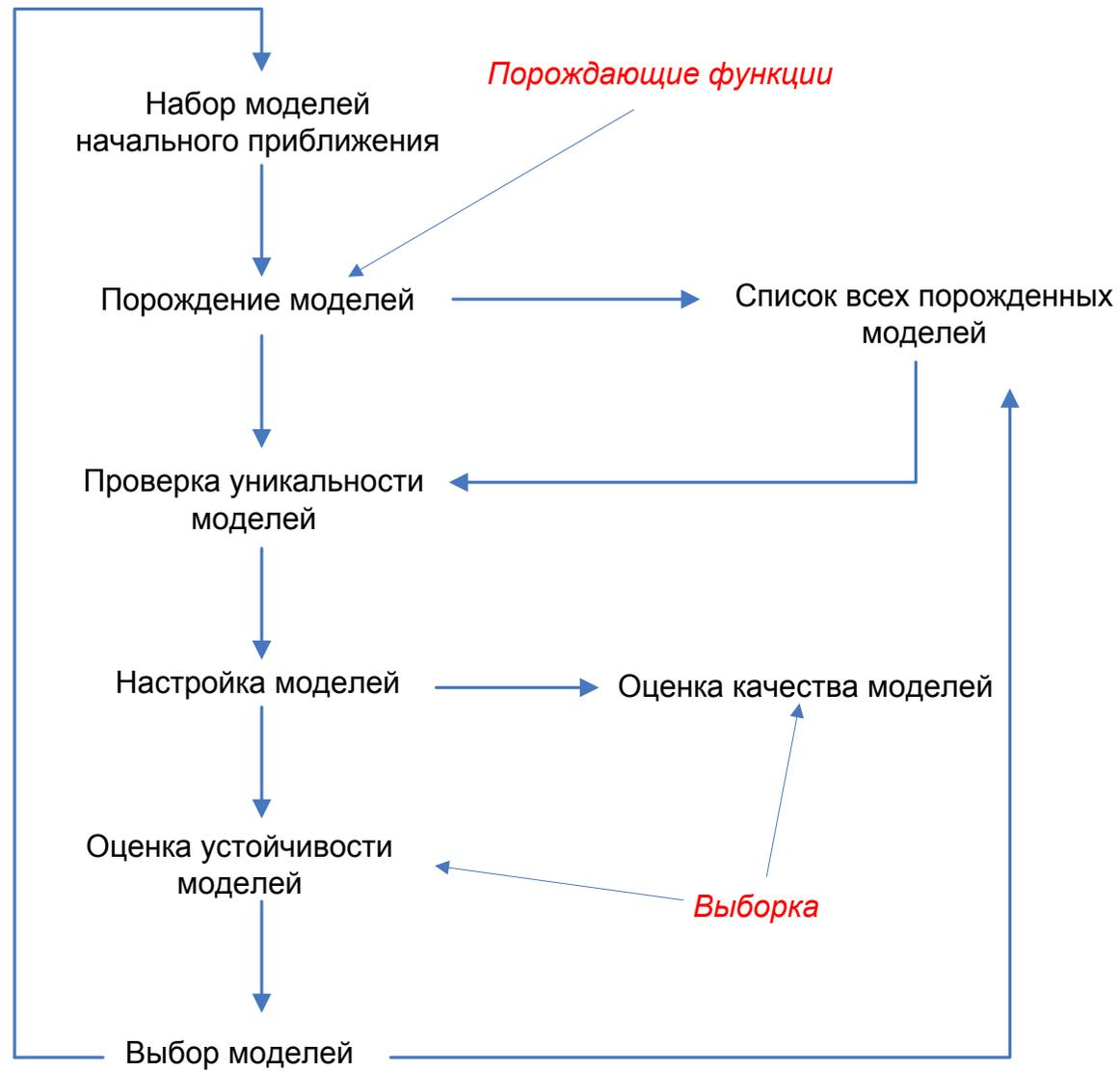
Упрощенная структурная схема системы порождения регрессионных моделей
